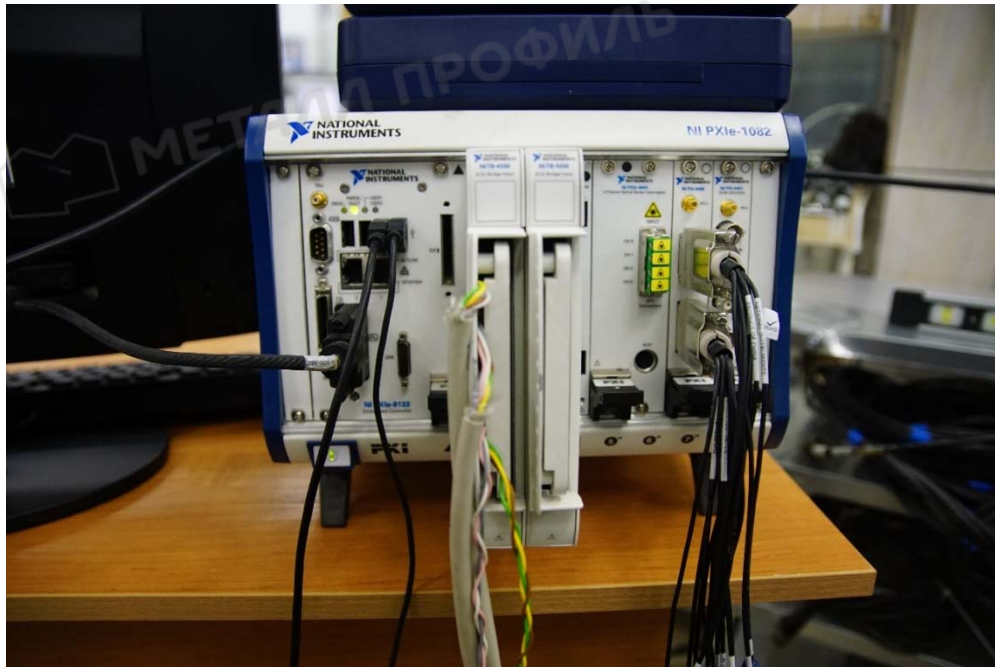
Рисунок 3.10. Комплекс оборудования NI PXIe-1082 с модулем NI PXI-4496 (для регистрации данных акселерометров)
