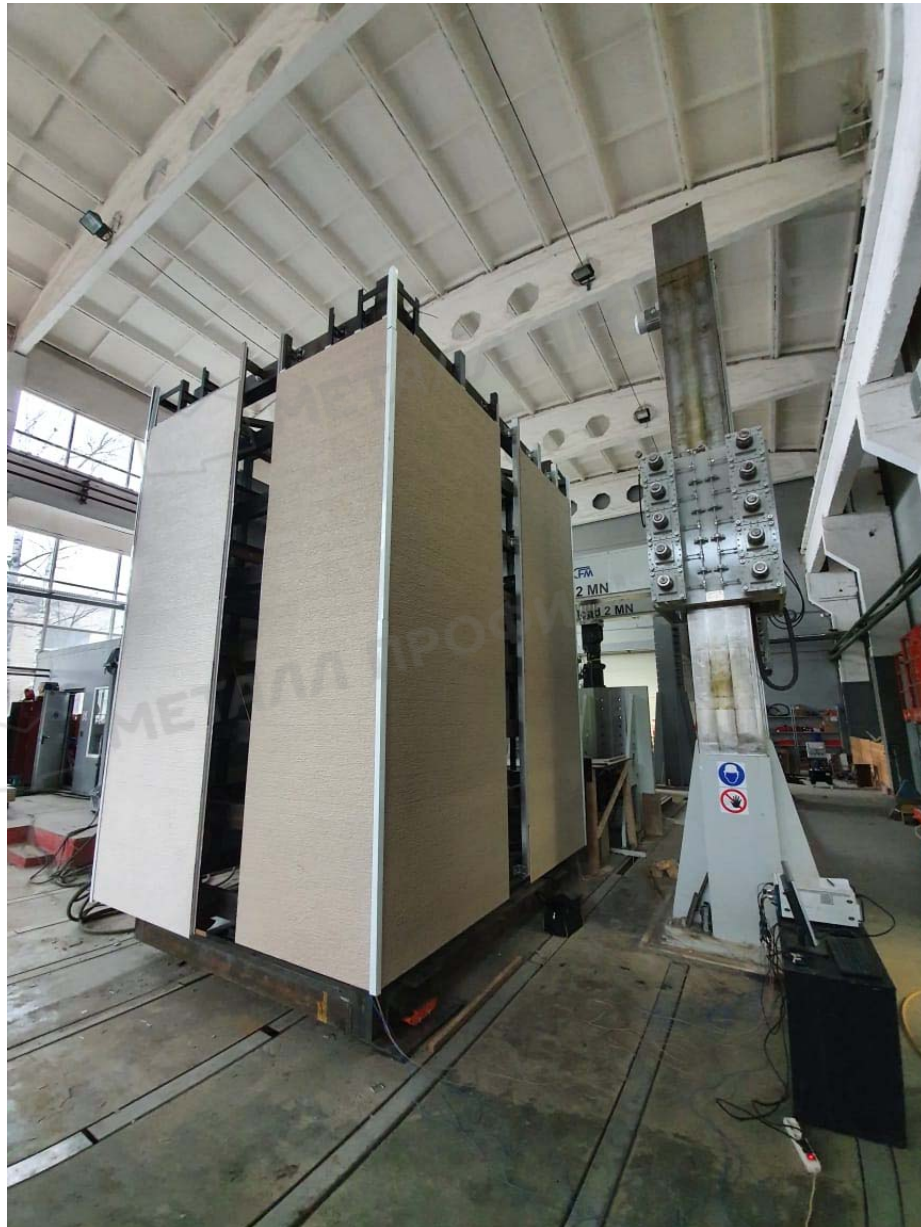
Рисунок 1.6 Общий вид стенда после завершения монтажа облицовочных панелей
